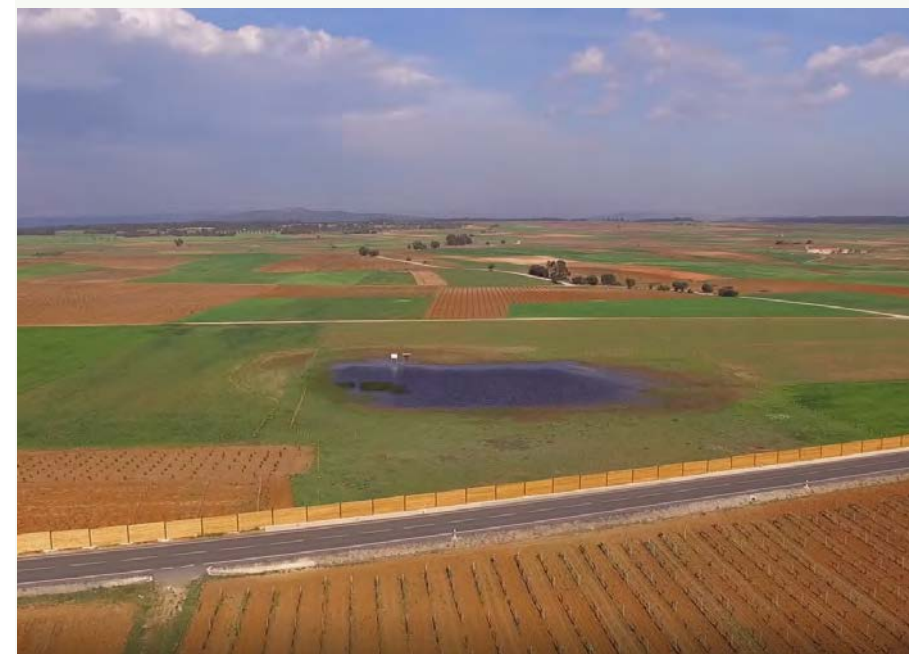
➤ Figura III. Lavajo del Jaral con la pantalla antisal instalada. Autor: Fernando Ramia.
