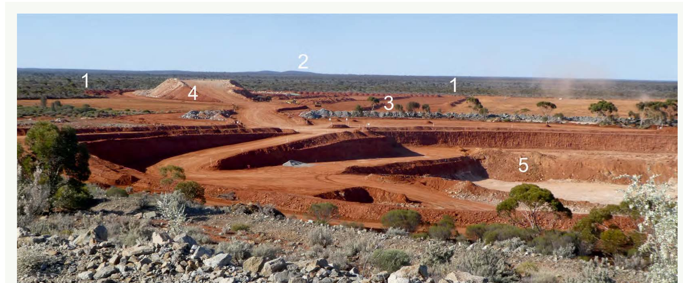
➤ Figura 1. Apertura de una explotación minera en Australia occidental. Al fondo puede intuirse el bosque original, sobre una gran llanura (1) salpicada por pequeños relieves residuales (2). En el centro (3) se observa la retirada del suelo; (4) muestra el inicio de construcción una escombrera exterior. A la derecha (5) pueden observarse las primeras fases de excavación de la corta o hueco minero (pit). Es en contextos como este donde la RG es necesaria, para integrar funcional y visualmente en su entorno todo el espacio transformado. Autor: J.F. Martín.
