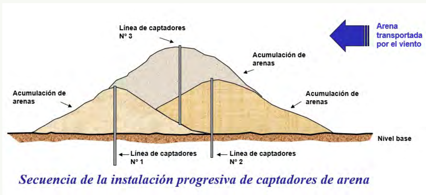
➤ Figura VII. Disposición espacial y temporal de los captadores pasivos de arenas.
