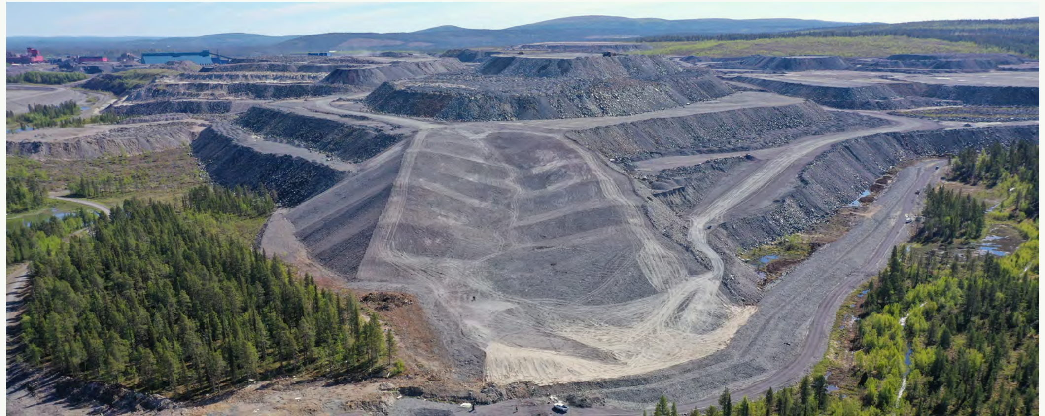
➤ Figura VI. Ejemplo de aplicación de GeoFluv en Suecia. La empresa VAST está desarrollando la RG en Escandinavia en ecosistemas muy sensibles ( tundra ). Desde 2020, ha realizado diseños para las minas Kiruna, Svappavaara y Malmberget, de LKAB. También para Copperstone, en la mina Viscaria, primer proyecto de Escandinavia que incluye un diseño de RG durante la fase de obtención de permisos. La imagen muestra el primer proyecto construido, demostrativo, de RG en esa región (mina Svappavaara). El diseño fue adaptado a un depósito existente de residuos mineros, para minimizar el movimiento de tierra y los costes. A su vez, se integró con un canal perimetral de drenaje para recoger la escorrentía y dirigirla a balsas de decantación, antes de conectar con las redes de drenaje naturales. Con ello, se demuestra la posibilidad de adaptar este tipo de soluciones a operaciones activas. Autor: VAST.
