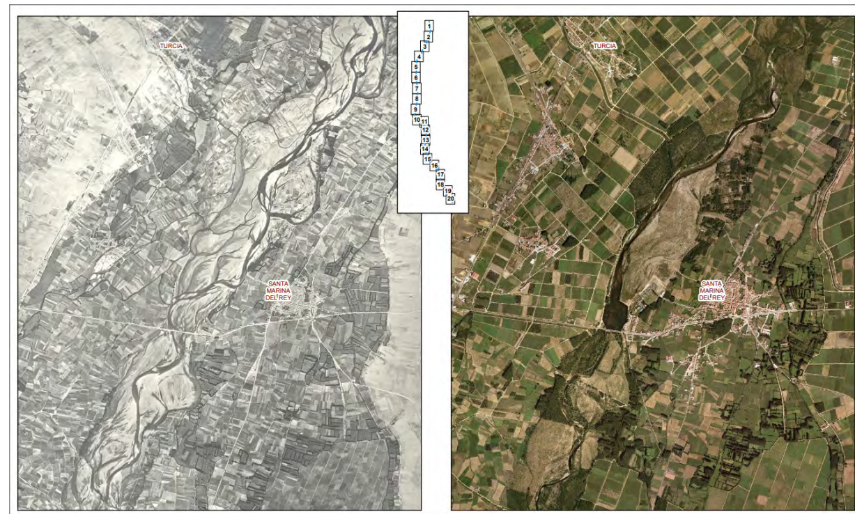
Figura I. Comparativa de suelos 1956-2006. Se observa la intensa ocupación del espacio fluvial y un cambio radical de morfología, que pasa de ser trenzada a un monocal canalizado. La ocupación de los terrenos implica su nivelación y relleno, operaciones de preparación previas para plantar choperas. Autoría: Confederación Hidrográfica del Duero.
