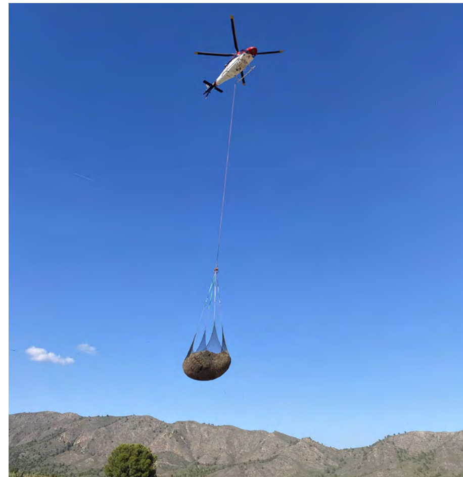
> Figura II. Carga de paja mediante la técnica helimulching. Autor: Ángel Martín González (Tragsa).
